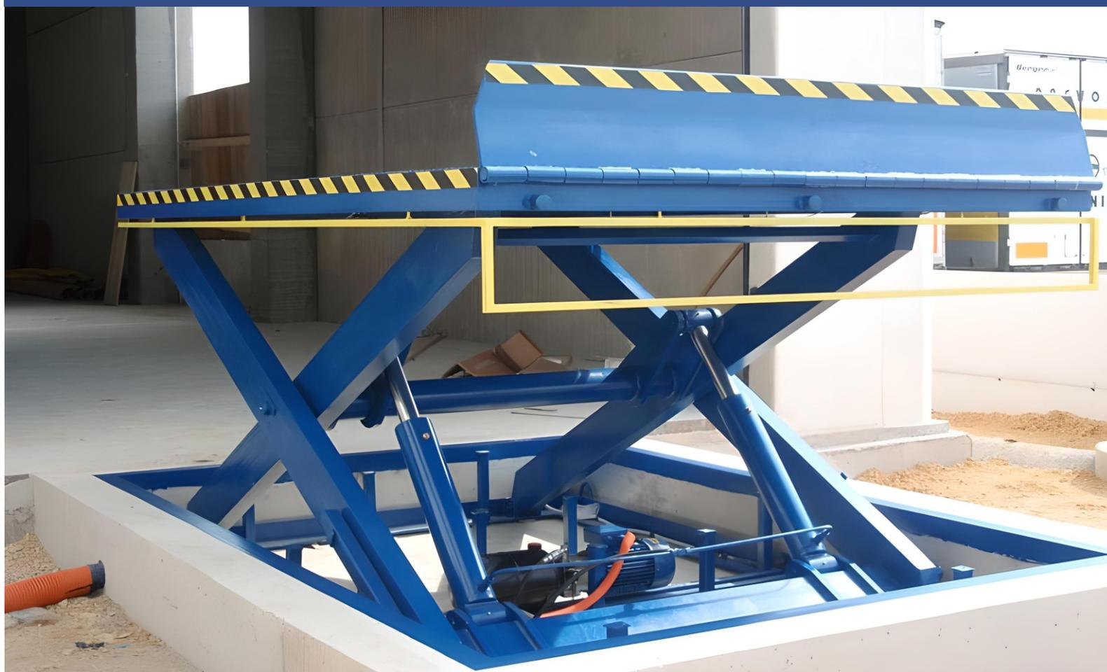
**Hidravlična dvižna miza** je sestavljena iz spodnjega in zgornjega okvirja (delovna ploščad), škarjastega dvižnega mehanizma, hidravličnega agregata in elektro opreme. Potrebno silo za dvig dajeta dva paralelno nameščena hidravlična cilindra. Hidravlični agregat in glavna elektro omarica sta lahko nameščena pod ali ob dvižno mizo. Škarjasti mehanizem je lahko eno, dvo ali več stopenjski. Število stopenj je odvisno od velikosti mize ter od želene višine dviganja.
